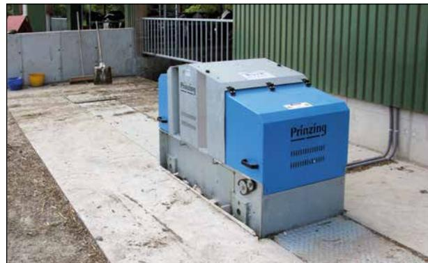
▲ Doppelantriebswinde DW7 mit Seilführung in einem abgedeckten Bodenkanal.
