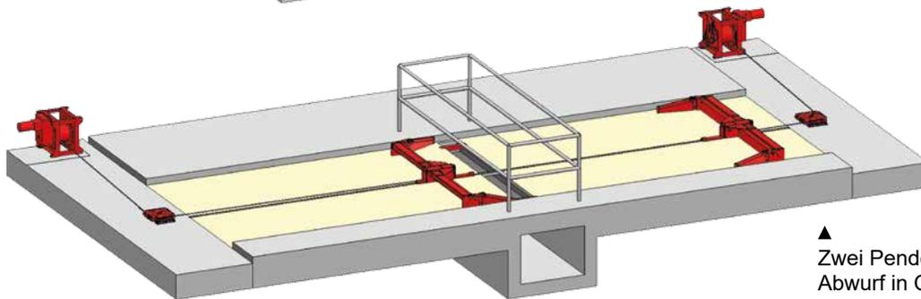
▲ Zwei Pendelklappschieber PKSF mit Abwurf in Querkanal Stallmitte.
