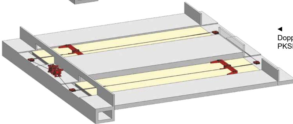
◀ Doppelanlage mit Pendelklappschieber PKSF. Abwurf in Querkanal am Stallende.
