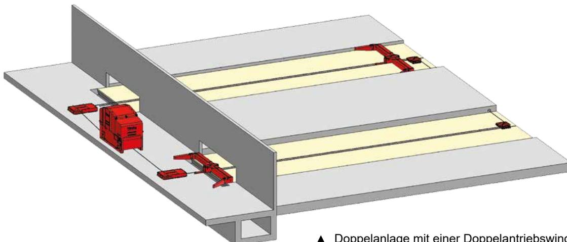
▲ Doppelanlage mit einer Doppelantriebswinde DW7
