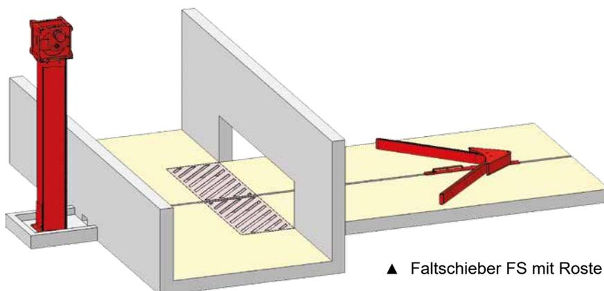
▲ Faltschieber FS mit Roste über Jauchegrube an Abräumfläche
