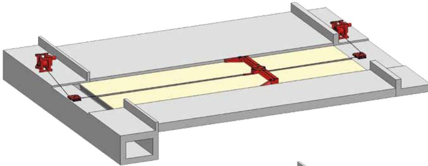
◀ Einzelanlage mit Pendelklappschieber PKSF. Abwurf in Querkanal am Stallende.
