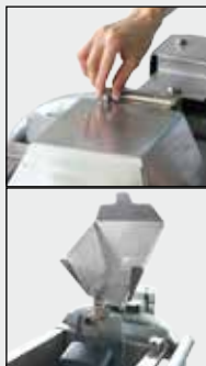
Werkzeuglos aufklappbare Schwimmerabdeckung
